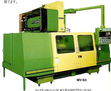
コンプリートカバーにより、加工中の切りくずやクランクの飛散を防ぐことができます。
