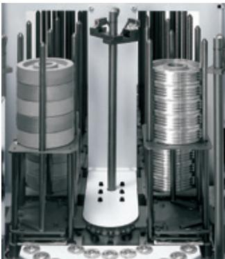
切りくずのトラブルが少ないボールキャスタ、ホイールコンベヤタイプを採用しています。
