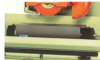
可傾式マグネットチャック 380×110×125 (幅×奥行×高さ) Tilting type electro-magnetic chuck 380×110×125 (W×D×H)
