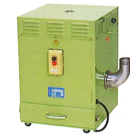
吸塵装置 幅×奥行×高さ(450×450×650) 使用モータ 0.4kW 風量 50Hz 150Q/sec、60Hz 180Q/sec 静圧 50Hz 170mmA g 、60Hz 250mmA g Dust collector
