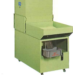
吸塵給水装置 (マグネットセパレータ付) 幅×奥行×高さ(540×1300×1300) 使用モータ 40W(給水用) 0.4kW(吸塵用) 25W(セパレータ用) 吸塵能力 50/60Hz、9.0/10.8m³/min ポンプ能力 50/60Hz、19/25Q/min マグネットセパレータ能力 20Q/min タンク容量 100Q Dust collector/Coolant device with magnetic separator
